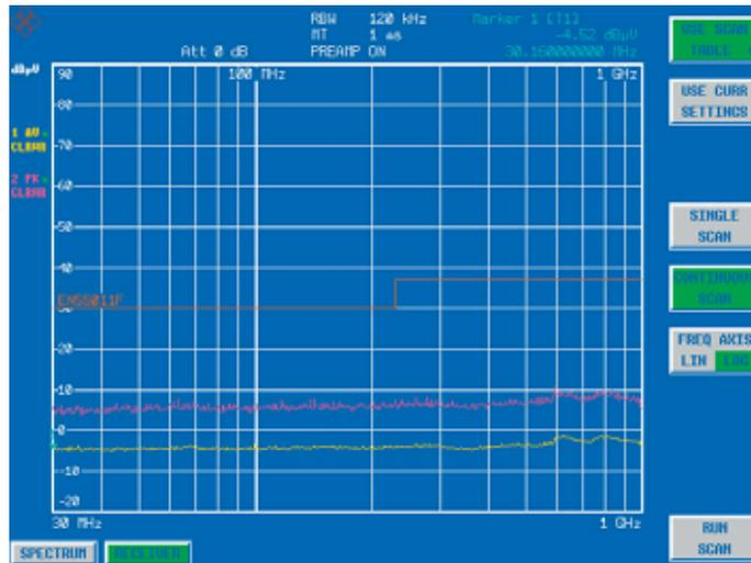
*Eigenrauschen mit eingeschalteter Vorselektion/Vorverstärker im Receiver Mode*
