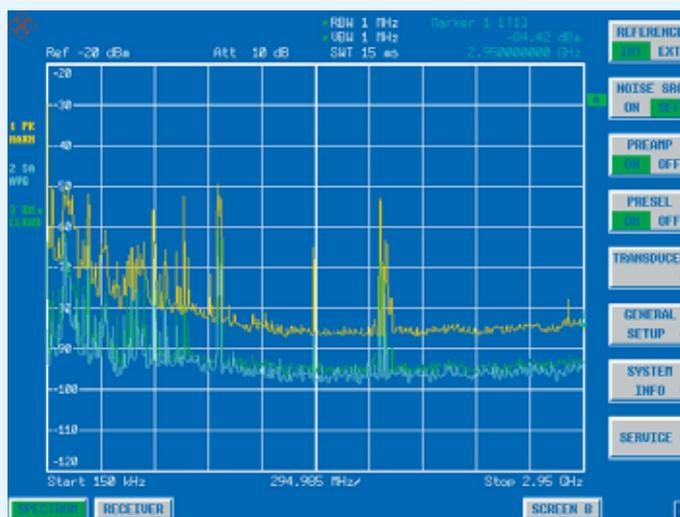
**Betriebsart „Spektrumanalysator“ mit eingeschalteter, wählbarer Vorselektion und Vorverstärker**
